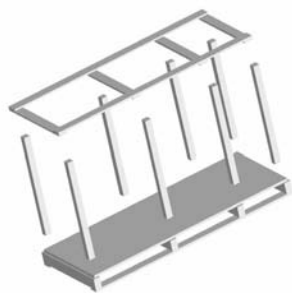
Внутренняя структура упаковки с картонными стенками;
