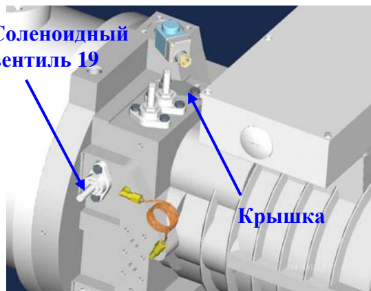
Конфигурация LZ (бесступенчатая);
